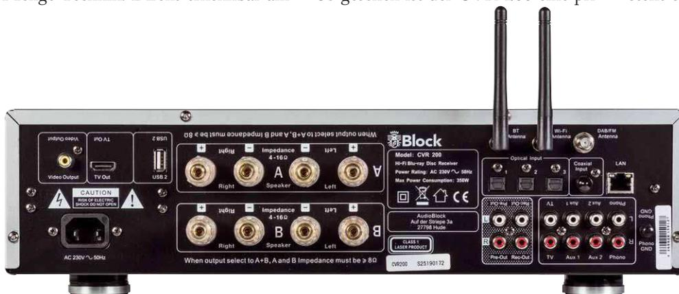
Reichhaltige analoge und digitale Anschlussmöglichkeiten, inklusive Netzwerkbuchse und Pre-outs. Eine HDMI-Buchse dient zum Anschluss an ein TV-Gerät. Zwei Antennen sorgen für besten Empfang von WLAN- und Bluetooth-Signalen
